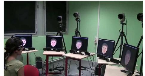
Figure 1 : dispositif de capture de mouvements pour le suivi de conversations multipartites
