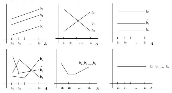
Le <u>parallélisme</u> des lignes traduit le fait que l'effet du facteur A (ou B) sur la variable réponse Y est le même quelque soit la valeur du facteur B (ou A). Les effets des facteurs A et B sont <u>additifs</u> et il n'y a pas d'effet de l'interaction entre les deux facteurs A et B sur Y.
