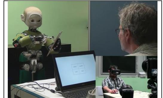
Figure 1. Le robot humanoïde Nina face à un sujet. L'incrustation montre le pilote qui téléopère le robot. Grâce à une technique de réalité augmentée, le support carton placé dans la main gauche de Nina est remplacé par un écran virtuel dans le champ de vision du pilote. Il peut alors, grâce à la souris qu'il a dans sa main droite, interagir avec cet écran virtuel pour prendre des notes ou afficher des instructions sur l'écran d'ordinateur du sujet.
