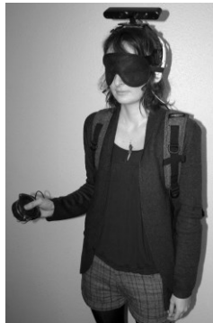
Système existant de substitution profondeur-son
