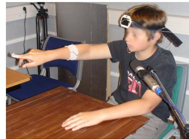
**Le dispositif OPTOTRAK de capture du mouvement.**
