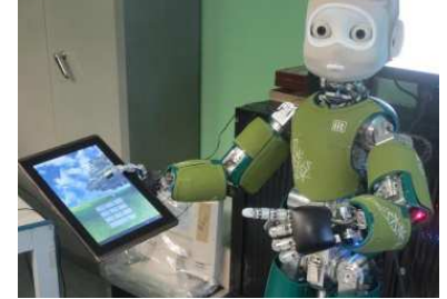
Figure 2 : Exemple de deixis brachio-manuelle effectuée par le robot Nina du GIPSA-Lab.
